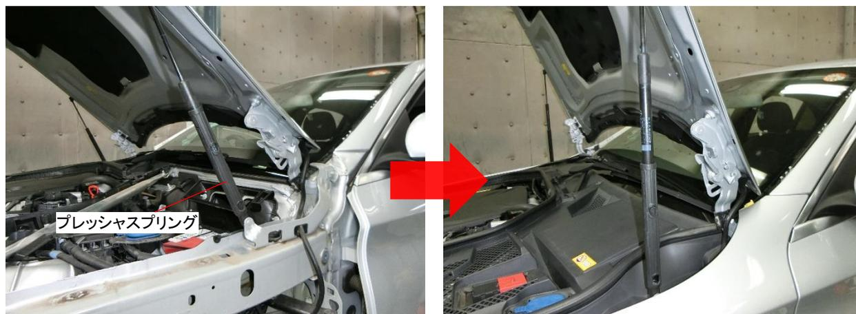
※プレッシャスプリング（フードダンパ）のロック部で縁切りする場合、ロックを取外してしまうとプリテンションが失われてしまうため、完全に取外さないように注意が必要。
