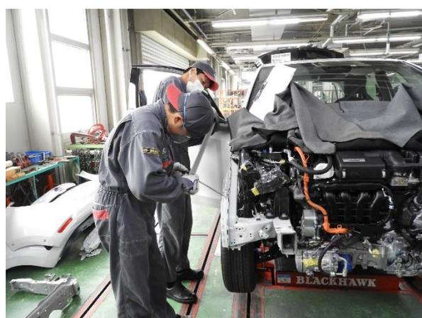
・修正したフロントサイドフレームの幅を含め、フロント骨格全体（長さ、対角、幅、高さ）を再確認、おのおのが規定値内であることを確認した上で、右フロントサイドフレームの半裁取替作業へ移る。
