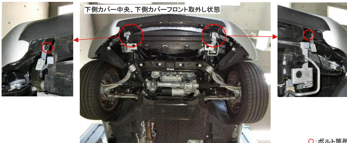
下側カバー中央、下側カバーフロントの順で取外します。
