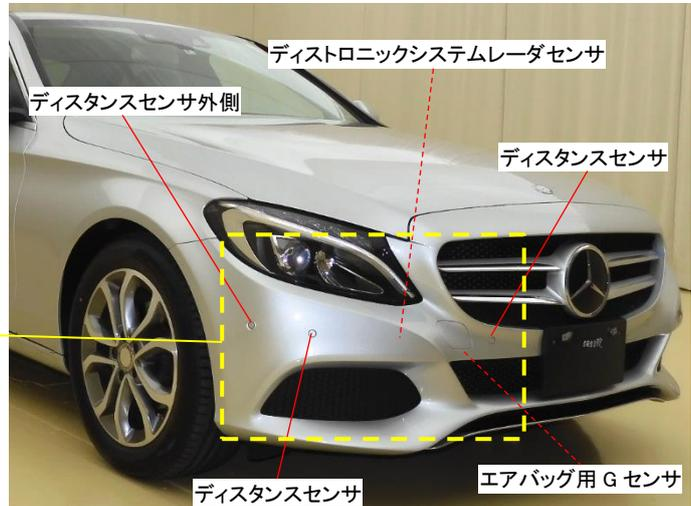
フロントバンパカバー脱着は、下側の取付けボルトは下側カバー中央および下側カバーフロントを取外して行います。
