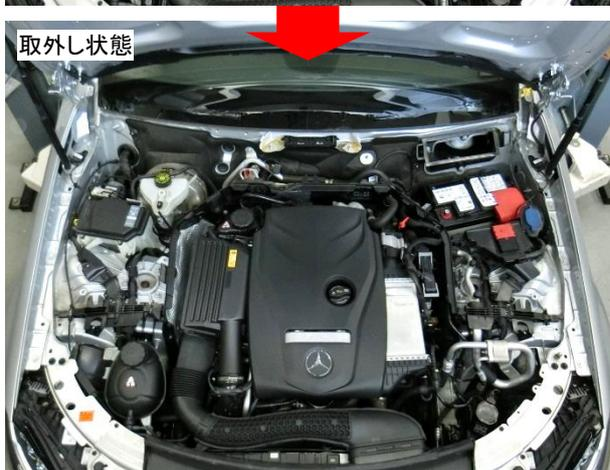
右側にはフューズボックスおよびブレーキフルード用のサービスホールカバー、左側にはエアコンガス用のサービスホールカバーが設定されています。
