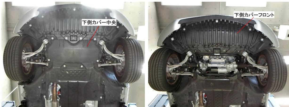
フロントバンパカバーとフロントフェンダはツメではなく、スクリュー2個で取付けられています。ホイールアーチ内は狭いため、ステアリングを切るなどしてスペースを確保して作業を行います。
