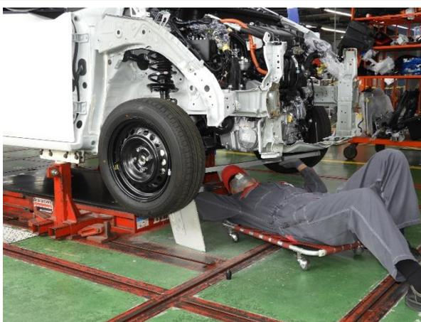
・2回目までの引き作業による復元状態の確認。対角方向は復元の傾向にあるが、右サイドフレームの引出しは不十分な状態であることを確認。
