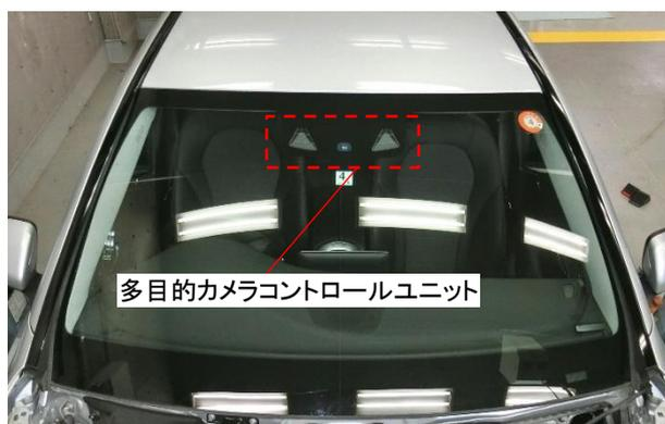
多目的カメラコントロールユニット（ステレオマルチパーパスカメラ）はフロントウインドウにはめ込まれています。センサカバーおよびミラーベースカバーを取外したのち、車両後方へスライドし取外します。
