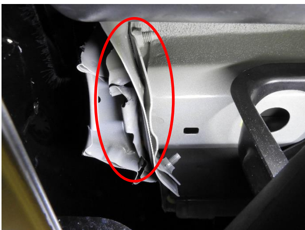
左リヤーフレームを下部から撮影しました。左リヤーフレーム先端部に変形がみられました。
