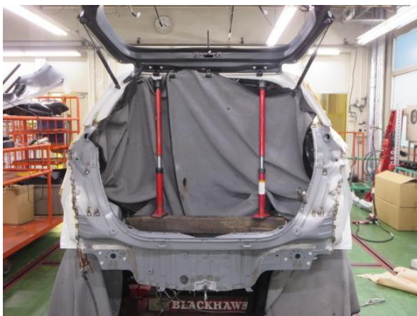
リヤパネル COMP を溶接して取付けました。
