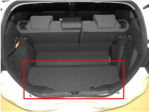
リヤーパネル COMP が押込み変形した為、スペアタイヤリッドが浮いています。
