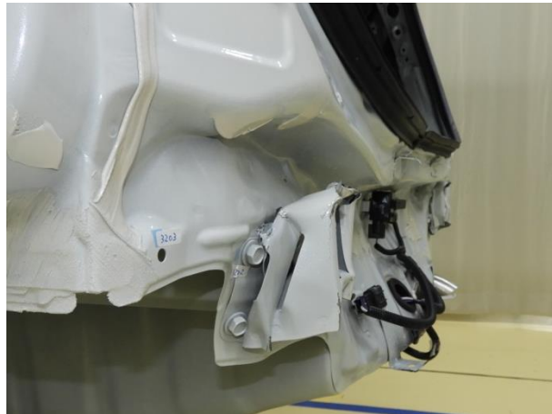
リアパネル COMP 上側を中心に押込みにより損傷していました。
