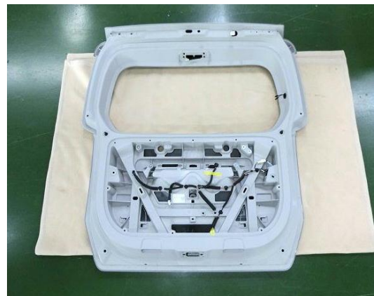
写真 2. 樹脂製バックドアパネル 補給部品 (裏面)
