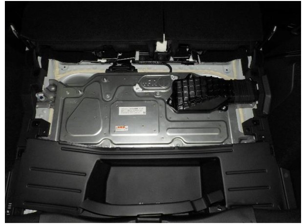
リヤーフロアパネルセット前方への波及損傷は見られませんでした。
