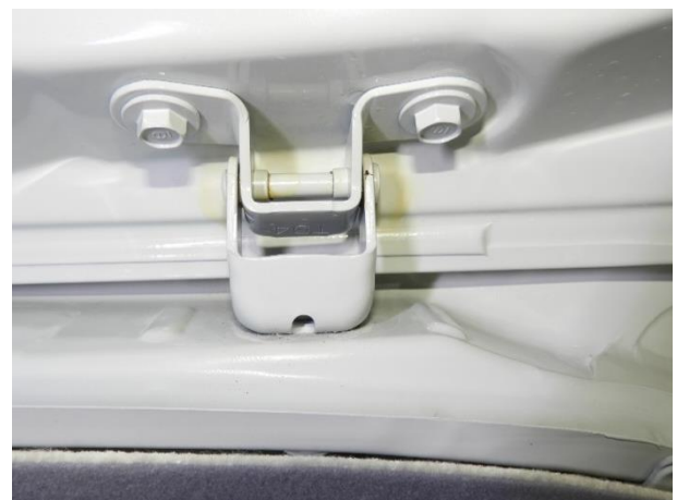
右テールゲート COMP ヒンジにはルーフパネル COMP との取付け部の隙間は正常でした。
