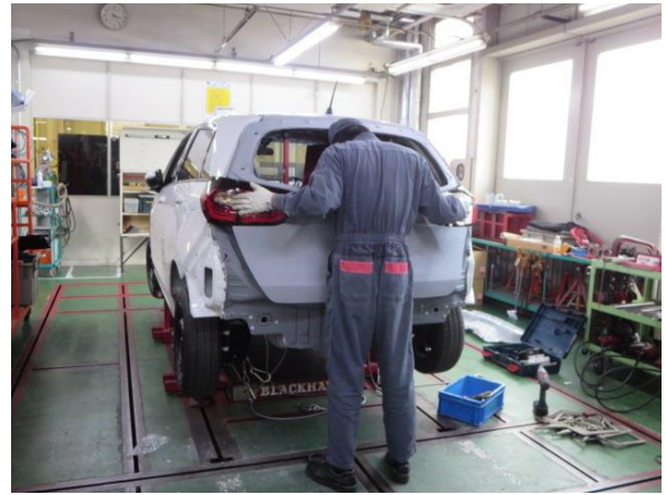
左右テールライト Assy を取付けて、各 부품の建付けを確認しました。
