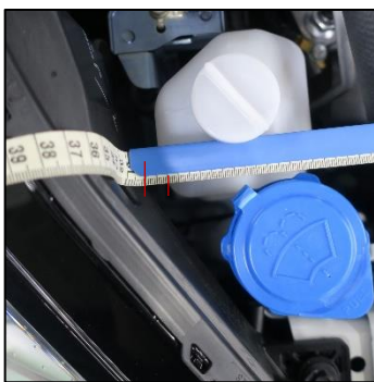
① 右ヘッドライト Assy とラジエタリザーバタンク
