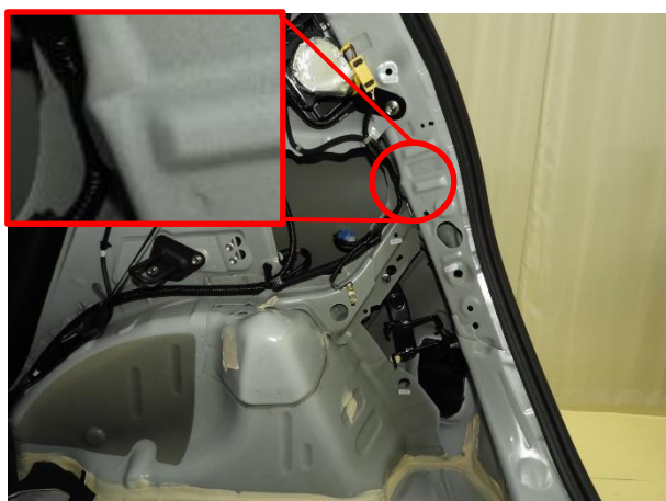
環状閉断面構造にあたる左右リアインサイドアップパネル部には押込みにより損傷していました。
