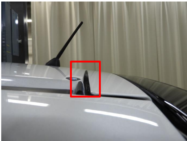
テールゲート COMP 上部を 9 時方向より撮影しました。押込みによりテールゲート COMP がルーフパネル COMP より下側へ移動しています(段差)。
