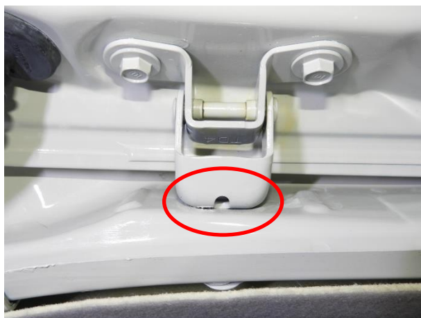
左テールゲート COMP ヒンジにはルーフパネル COMP との取付け部の隙間が広がっています。
