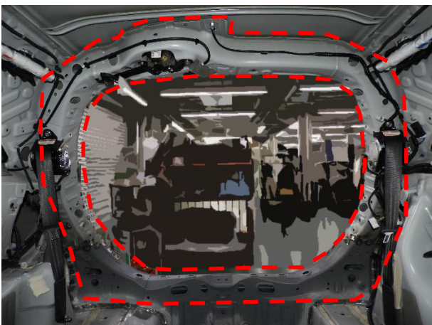
テールゲート COMP 開口部は強固な環状閉断面構造となっています。
