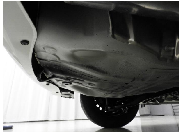
リヤーフロアパネルセットを下部から撮影しました。リヤーフロアパネルセット中央部への波及損傷は見られませんでした。
