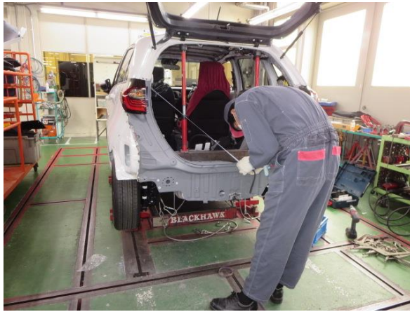
溶接パネルを仮付けした状態で、各部の寸法を計測しました。
