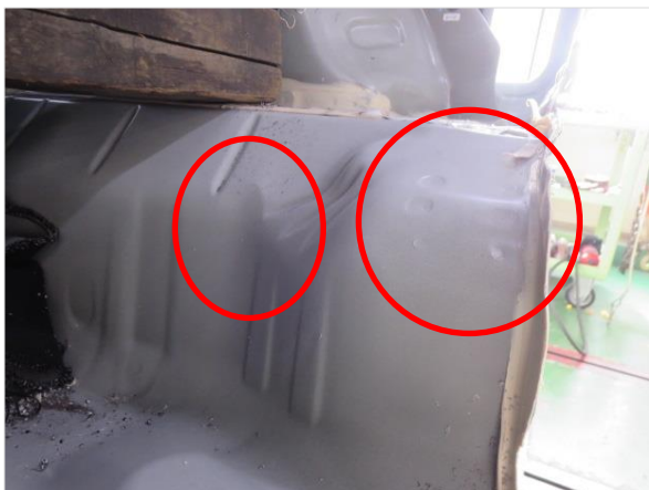
リアフロア部の損傷状態
