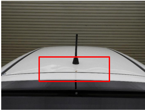
リヤパネル COMP が押込まれたことにより、ルーフパネル COMP に損傷が見られました。
