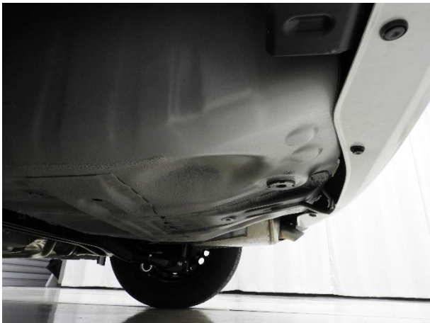
リヤーフロアパネルセットを下部から撮影しました。リヤーフロアパネルセット中央部への波及損傷は見られませんでした。
