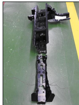
補給部品より、リインフォース部分 のみを取外した状態
