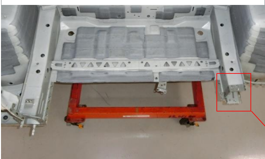
トランクルームフロア後部、リヤサイドメンバ後部、サイドメンバ補強部後部取外し状態
