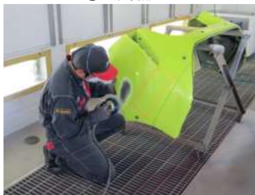
②塗膜剥離
