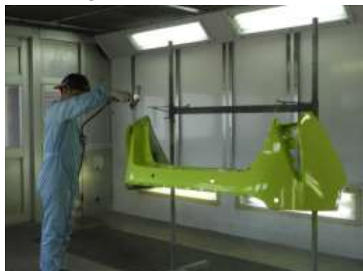
⑫上塗り～仕上げ作業
