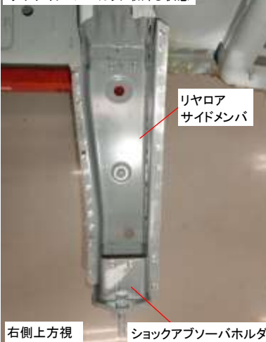
リヤサイドメンバカット取外し状態
