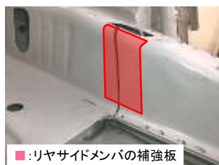
■: リヤサイドメンバの補強板
