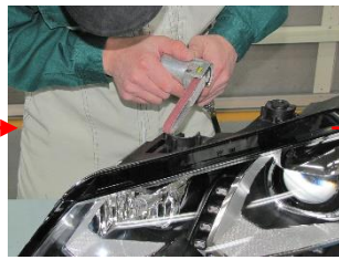
ベルトサンダ等で取付可能な形状に修正する。
