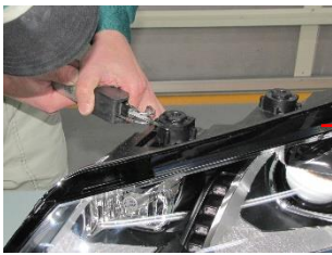
リペアキットに合わせて損傷部を切断する。
