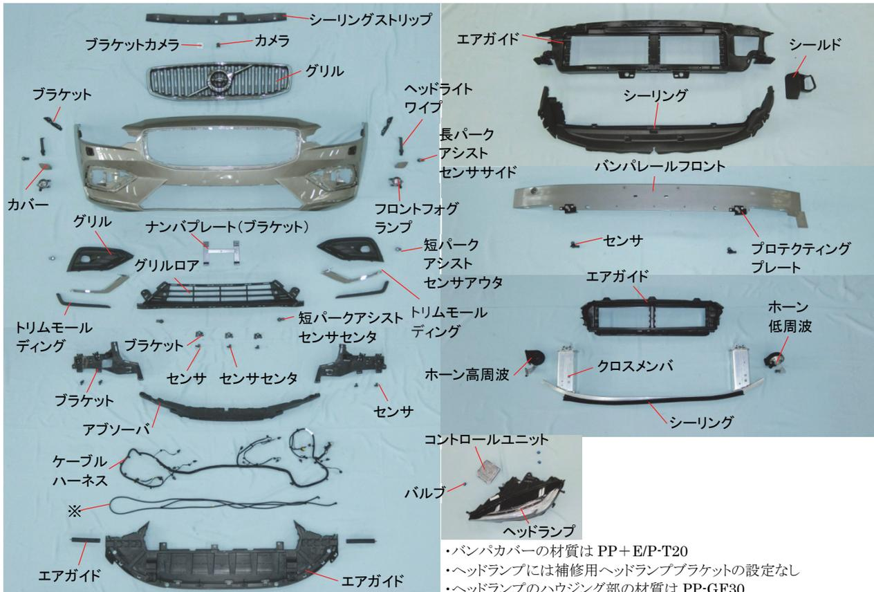
※の部品は分解していません。ホースおよびクイックカップリングで構成され、それぞれ単品で補給が設定されます。
