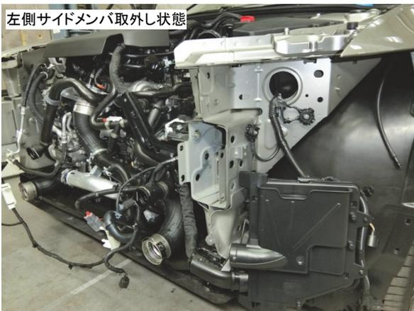
サイドメンバは、損傷に応じて上写真のボルト箇所までの範囲で取替えることができます。ただし、それより後部のサイドメンバ半裁取替作業は設定されていません。
