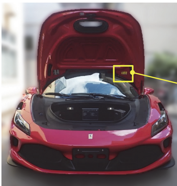
塗装表示位置（トランクフード裏面）
