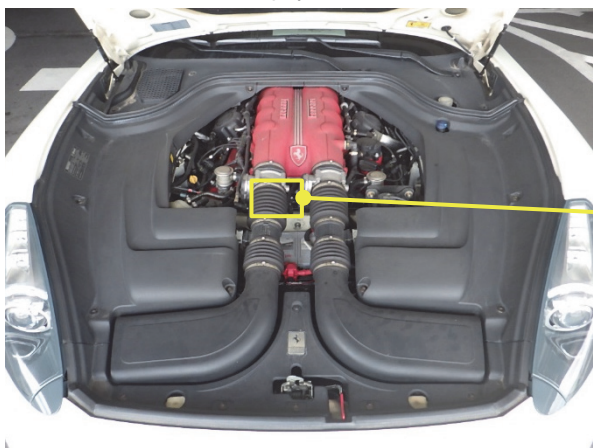
ASSEMBLY ナンバー位置 （エンジンルーム内フレーム上面）
