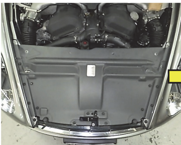
塗装表示位置（エンジンルーム内フレーム上面） ※カバーを外す
