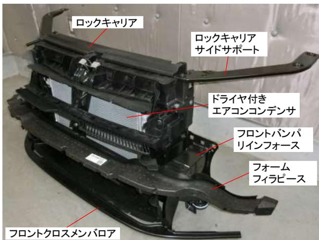
ロックキャリアはフロントバンパラインフォースを介してサイドメンバに取付けられています。フロントバンパラインフォースはクラッシュボックス一体型で、下部に別補給のフロントクロスメンバロアが取付けられています。
