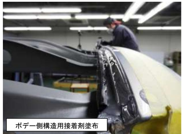
(9) ボデーとルーフパネル上面の隙間から、接着剤を充填し、余剰分を拭取りながら、ヘラで平滑になります。
