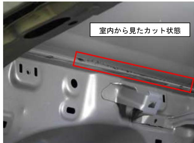
(3) ルーフレール、ルーフアーチとルーフパネルとの間のボデーシーラをカッタや針金を使って切断し、ルーフパネルを取外します。
