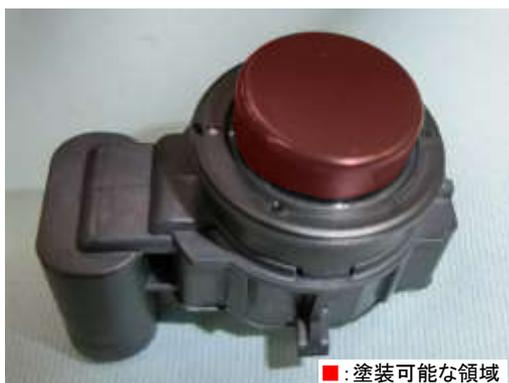
フロントセンサ、フロントセンサパークアシスト用、リヤセンサパークアシスト用およびリヤセンサパーキングエイド用は、塗装できる範囲が限定され、膜厚も最大 125  $\mu$ m となっています。
