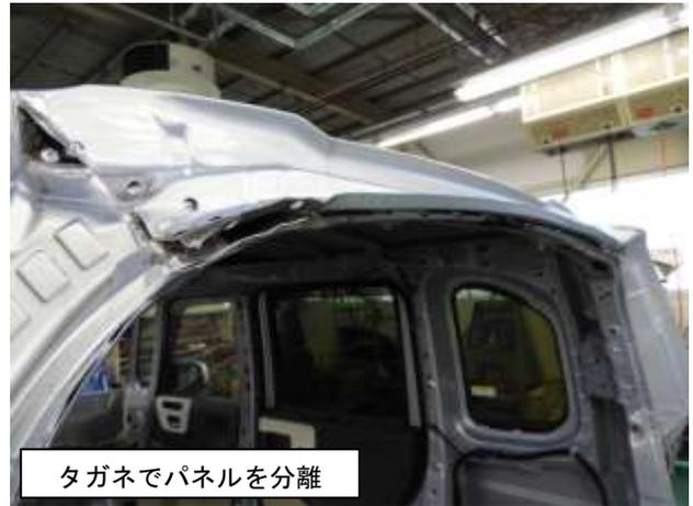
(2) ボデーを傷つけないよう養生し、エアソーで5mm程度端部を残してルーフパネルを粗切りします。
