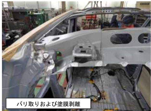
(2) レーザブレイジングで接合されていた箇所は、補修時には構造用接着剤で接着します。
