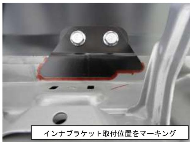
(5) 新品ルーフパネルを一旦外し、塗膜剥離と防錆シーラを塗装したインナブラケットをマーキング位置にバイスで固定し、ボデーにスポット溶接します（インナブラケットCのみ隅肉溶接あり）。
