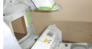
左記以外のリベット箇所、接着剤塗布箇所、EMCボルト箇所はリヤパネル外側で紹介した範囲と同じです。また、補給部品のインナテールパネルの加工は不要です。
