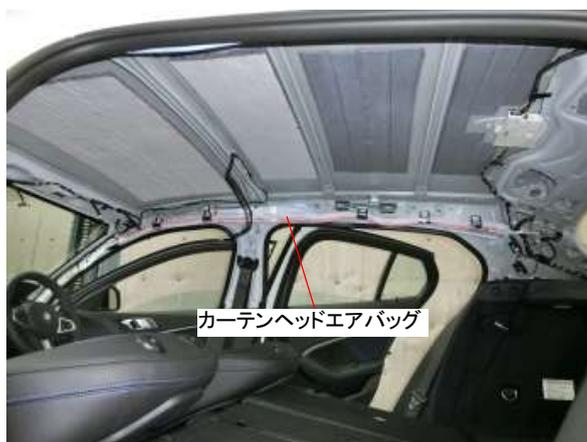
カーテンヘッドエアバッグは、サイドボディ上部にメタルクリップで取付けられており、脱着・取替作業の際は、ルーフ内張り（ヘッドライニング）を取外す必要があります。
