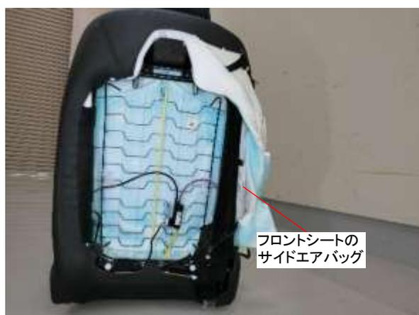
背面のカバーを取外し、バックレストカバーをめくると確認できます。
