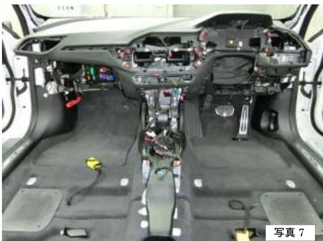
センタコンソール、カバーおよび操作パネル類、インストルメントパネルの順で取外します。
