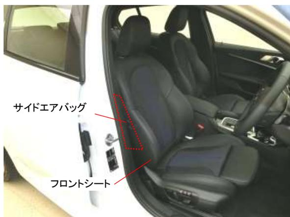
サイドエアバッグは、フロントシートに組付けられているため一体で取外します。運転席は電動シートのため、取外すにはバッテリーの接続（電源供給）が必要となります。
