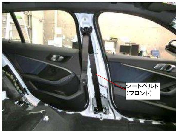
シートベルト（フロント）は、Bピラー内側にボルトで取付けられており、リヤシートクッションおよびフロント・リヤのエントランスカバーレール、Bピラートリムアッパ・ローを取外して作業をします。ベルトの端部はフロントのシートレールに取付けられています。
