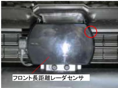
フロント長距離レーダセンサの調整にACC調整ユニットを使用しますが、条件を満たした場所で行うことが前提です。目視点検ののち損傷や変形があった場合には部品を新品に交換します。診断システムを接続し、フロントレーダセンサのセットアップを行います。写真の○印のボルトをSSTで回して調整します。
