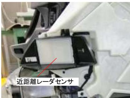
近距離レーダセンサは前後左右で4個あります。構造は同じですが、右リヤの近距離レーダセンサがコントロールユニットの役割を持ちます。取外した後や取付場所を変更した場合にコーディングが必要になります。
