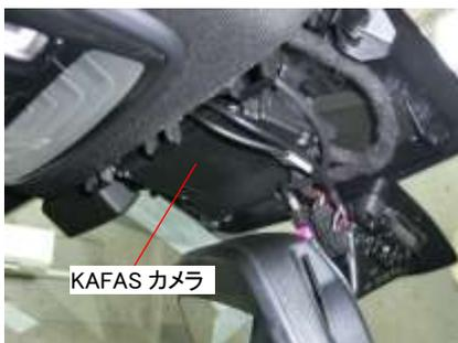
KAFASカメラの交換あるいはフロントガラスを交換した際、プログラミングシステムと接続し処理しますが、必要に応じてワークショップシステムに接続し、ディフェクトメモリを消去します。プログラミング/コーディングが完了したら、プログラミングシステムを車両から分離します。
