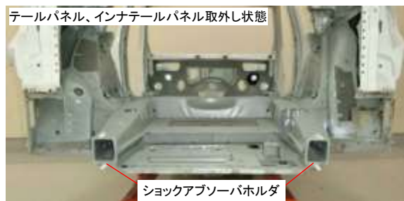
テールパネル、インナテールパネル取外し状態(右側内側視)
