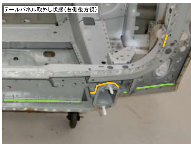
テールパネル、インナテールパネル取外し状態(右側内側視)
