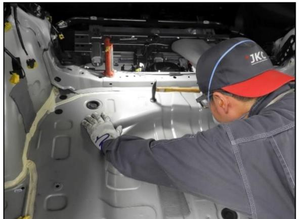
⑤ 左右リヤフロアサイドメンバサブ Assy リヤ上部に残ったリヤフロアパンの損傷は、パテで修正しました。
