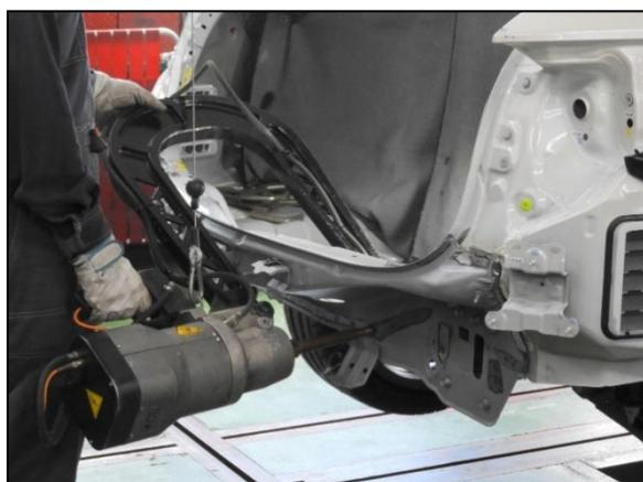
(5) ボデーローバックパネルサブ Assy 裏面にシーリングを施してボデー修理作業を完了しました。
