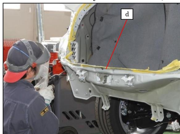
② 溶接点を切削後、溶接フランジに接着剤が塗布されているので、温めて外しました。
