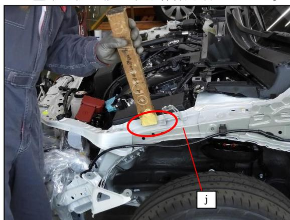
⑤ k.左右フロントサイドメンバサブ Assy 前端部が僅かに左右外側へ広がっていたので、損傷したl.フロントサイドメンバブラケットサブ Assy を取付けチェーンブロックで内側へ引寄せました。
