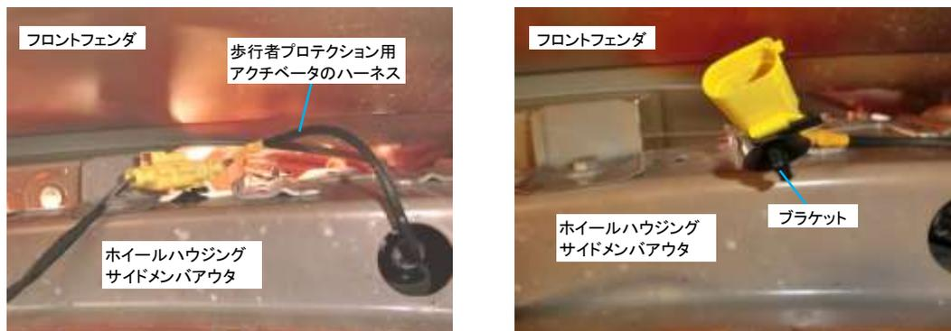
※掲載写真は構造が分かりやすいようにフロントホイールハウジングを取外して下方より撮影
