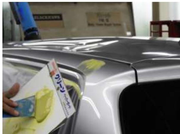
③乾燥後、板金パテを研ぎ、ポリパテ 1 回仕上げで塗装工程に進められる状態まで形を整形します。
