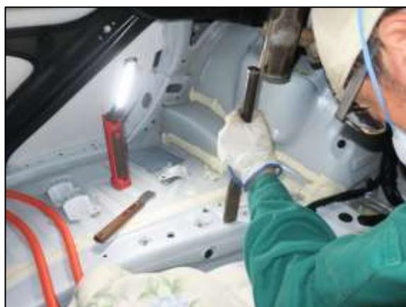
⑤ 残った歪みをとるため、リヤフロアパネルブレースサブ Assy のボルト穴を利用しプルプレートを取付け、部分的な引き作業を行いながら、サイドメンバトゥーフロアラインホースサブ Assy をハンマリングやワッシャ溶植機を用いて修正しました。
