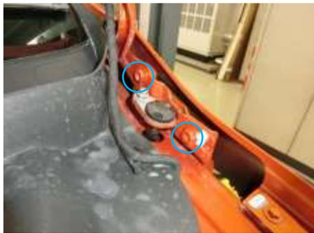
②リッド用ヒンジ取付けボルトを取外す
