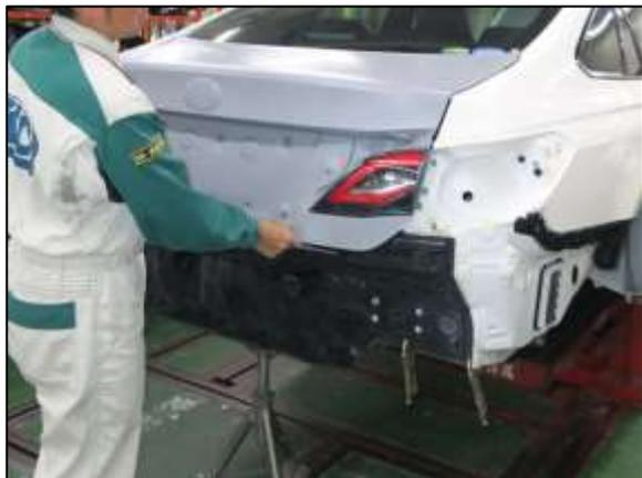
② 基準と一致したので関連部品を取外して本溶接し、後部骨格修理作業が完了しました。
