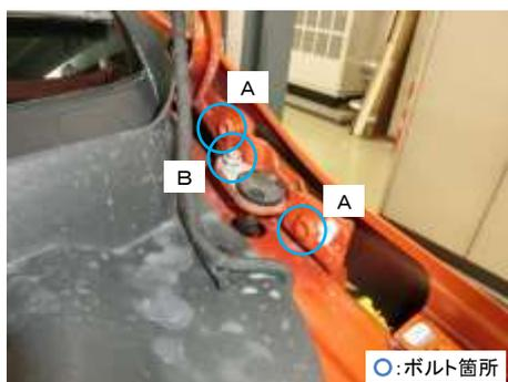
A：リッド用ヒンジと車体（フロントヒンジラインハウジング）との締結
