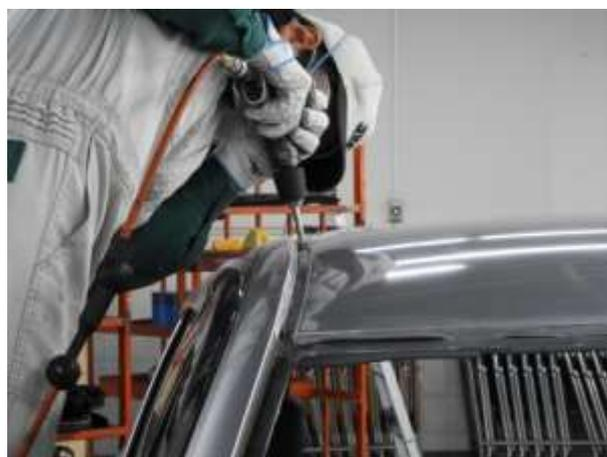
③バーナで加熱し、ルーフパネルとルーフパネルラインホースメント間のシーラを剥がし、タガネでルーフパネルの取外しを行います。
