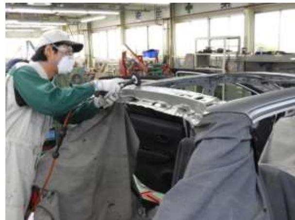
⑥ 損傷したルーフパネルに残ったバックドアヒンジを取外します。
