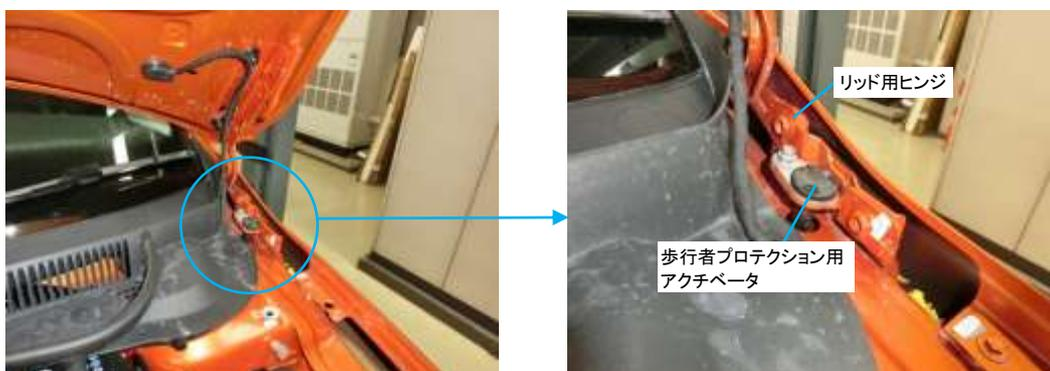
\*1：アクティブボンネットとは、事故が起きた後の被害を抑える二次被害防止システムの一つで、「歩行者との衝突を検知すると、瞬時にボンネットの後端を数センチ持ち上げてエンジンとの間のスペースを拡大し、歩行者の頭部への衝撃を低減させるシステム」です。
