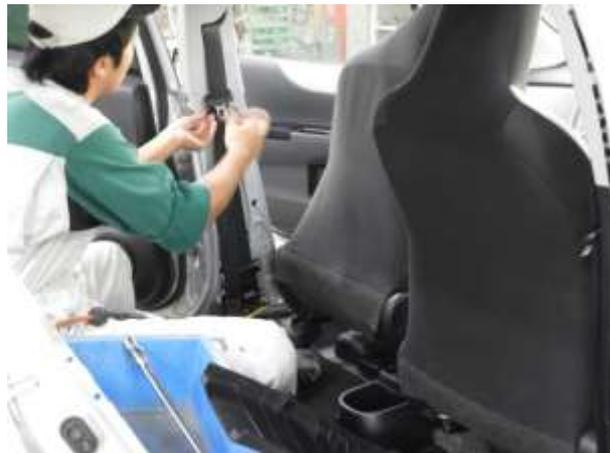
② フロントガラス、バックドア、左右ルーフドリップサイドフロントモール、ルーフヘッドライニングの取外しを行い、続いて室内の養生を行います。バックドアヒンジについては取付けナットのみ取外します。
