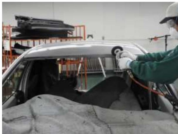
②スポット溶接をスポットカッターで切削します。
