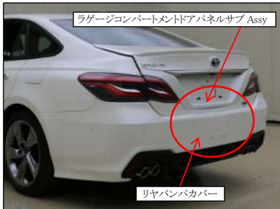
② ボデーローバックパネルサブ Assy、リヤフロアパンサブ Assy が損傷 (赤丸部) していました。
