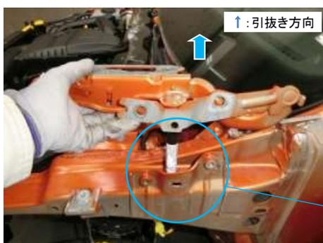
左写真のように、ブラケットが付いた状態でリッド用ヒンジおよび歩行者プロテクション用アクチベータを一体で取外そうとすると車体側（ホイールハウジングサイドメンバアウト）のサービスホールにブラケットが引っかかってしまいます。
