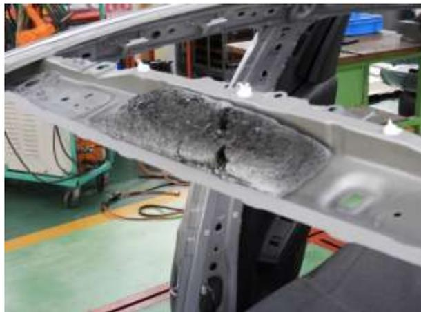
②車両へルーフパネルを仮付けし、隣接関係部品の建付けを点検します。
