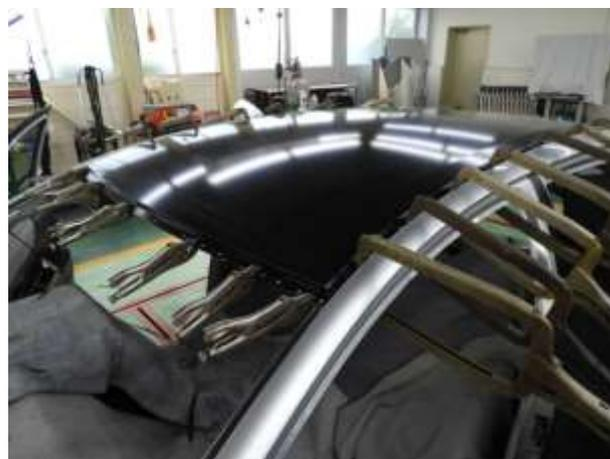
③ルーフパネルを本溶接し、余盛りをベルトサンダで研磨します。
