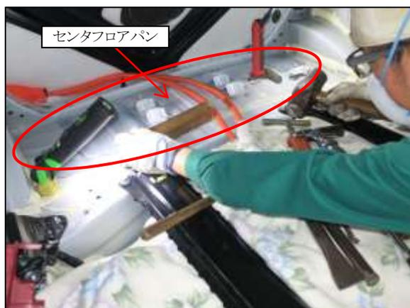
④ 左右リヤフロアパネルブレースサブ Assy を取外し、ハンマリングにて修正しました。
