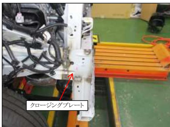
(6) 外装部品を取付けて各部品の建付けを確認し、前部骨格修理作業が完了しました。
