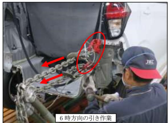
③ 左リアピラーレインフォースも同様に損傷（赤丸部）が残っていたので、6時方向へ引き作業を行いながらハンマリングにて修正しました。
