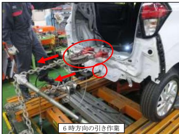
② 左右バックアウトパイラーにクランプを取付け、6時方向へ引き作業を行いました。
