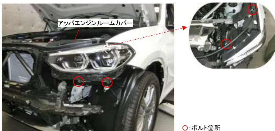
ヘッドライトのブラケット部が損傷した場合の補修用パーツとして、ヘッドライトリペアキットが設定されています。
