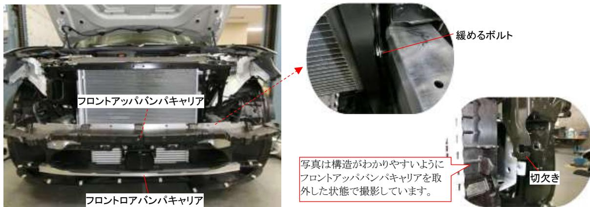
フロントアッパバンパキャリアには、モジュールで組付けられる際の位置決めピンがあり、ホルダヘッドライトを残して取外す作業では干渉してしまうため、ドリルを使用してピンを取外します。なお、フロントアッパバンパキャリアを取替える際は新部品からピンを外してから取付けます。
