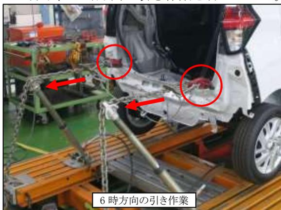
③ 左右バックアウトパイラー上部にクランプを取付け、6時方向へ引き作業を行いました。
