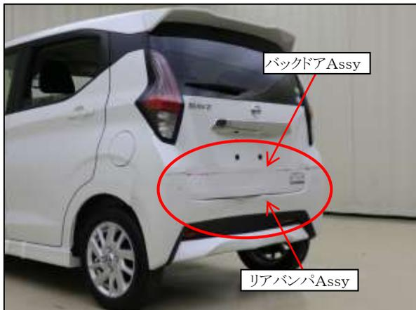
② リアアップパネル、左右バックアウトピラーが損傷 (赤丸部) していました。
