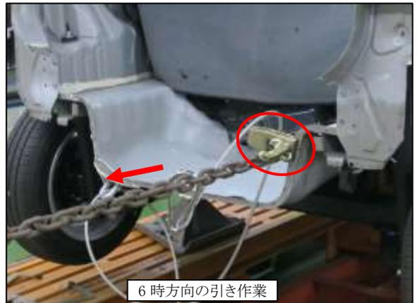
⑧ 引き具を取外し、残った損傷をハンマリングにて修正しました。
