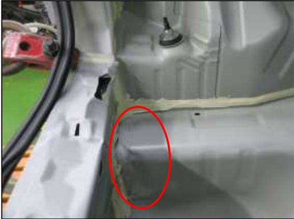
⑦ リアリアフロアのフランジ部にクランプを取付け、6時方向へ引き作業を行いました。
