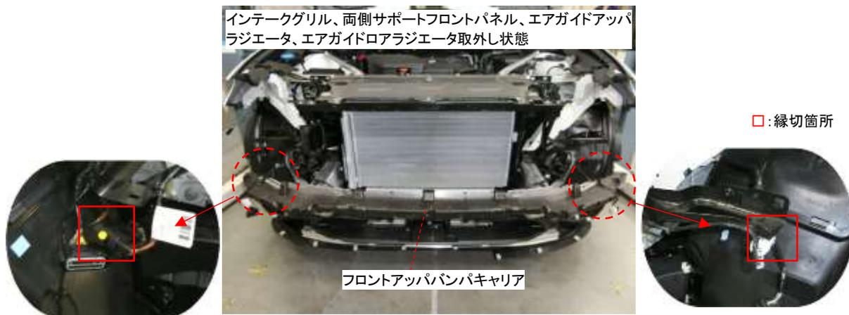
フロントアッパバンパキャリア内側の取付けボルトは、左右共に取付け相手部に切欠きがあるため、ボルトを緩めることで取外しが可能です。
