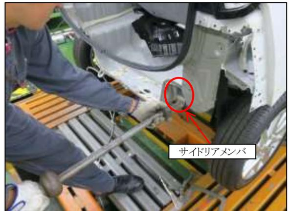
⑥ リアリアフロア端部に損傷が残っています。
