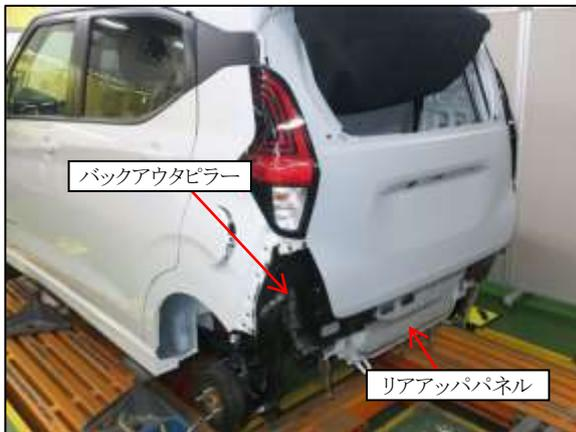
② 立付けが基準と一致したので関連部品を取外して本溶接し、後部骨格修理作業が完了しました。
