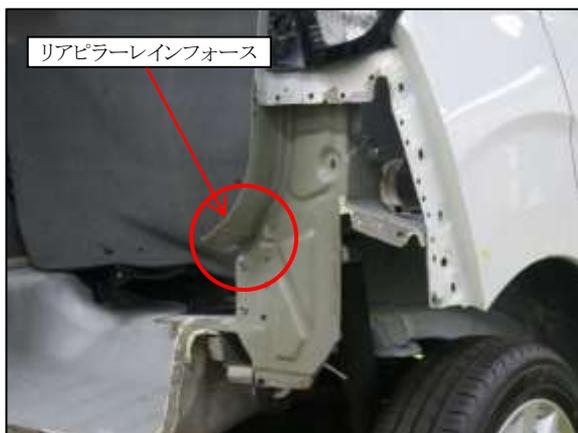
② リアピラーレインフォースにクランプを取付け、6時方向へ引き作業を行いながらハンマリングにて修正しました。
