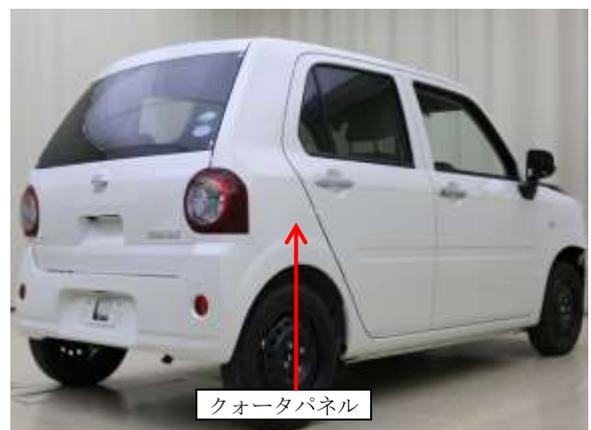
⑤ボデーロウバックパネル、左クォータパネルエクステンションリヤロウが損傷しています。
