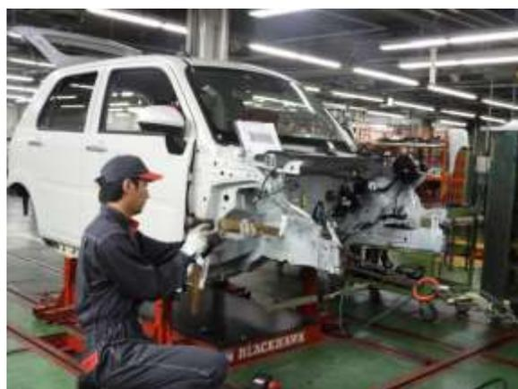
⑧計測器具を使用して右フロントサイドメンバサブ Assy の寸法復元を確認しました。
