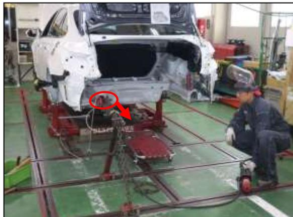
③ 右リヤフロアサイドメンバインホースメントリヤは、右へ寸法移動していたので、9時方向へ引き作業を行いました。
