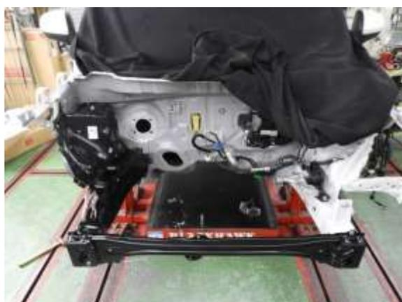
②フロントサイドメンバプレートサブ Assy はフェンダエプロン部とフロントサイドメンバアウト部が一体で補給されます。
