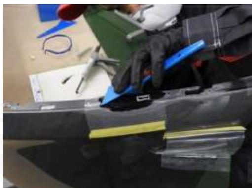
⑦フィルムを外し、シングルサンダを使用して充填部の形を整えます。
