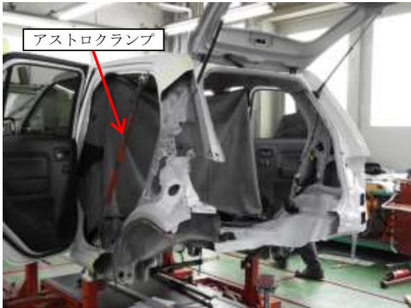
②リヤフロアサイドメンバサブ Assyを溶接点で取外します。
