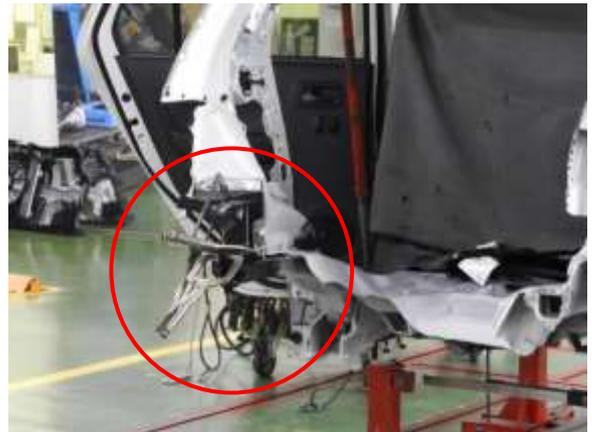
②クォータパネルを仮付けしてクォータパネルエクステンションリヤロワの取付位置を確認します。
