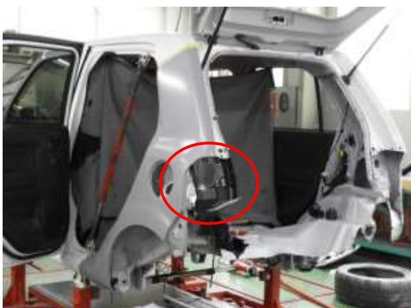
③クォータパネルエクステンションリヤロワの位置が決まったらクォータパネルを取外してクォータパネルインナロワの取付位置を合わせます。
