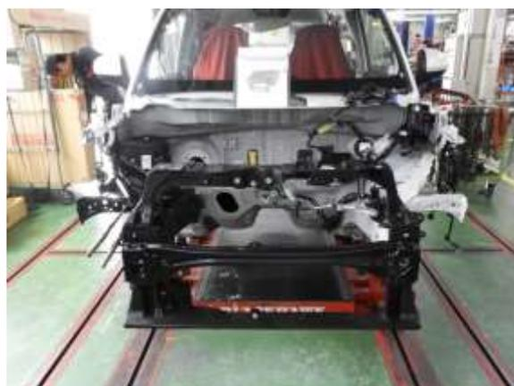
④フロントバンパカバー、左右ヘッドランプ LED ユニット、フードサブ Assy、左右フロントフェンダパネルを取付けて立付けを確認しました。
