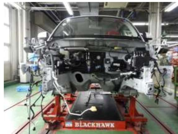
④右フロントサイドメンバプレートサブ Assy が損傷しています。
