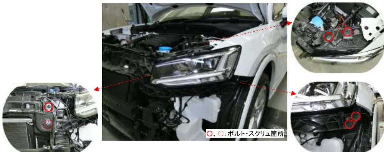
ヘッドライトのブラケット部が損傷した場合の補修用パーツとして、ヘッドライトハウジングリペアキットが設定され一台分（左右セット）で補給されます。
