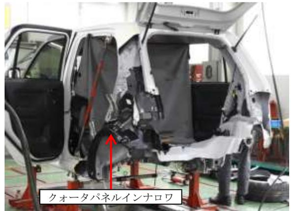
④ボデーロウバックパネルを仮付けします
