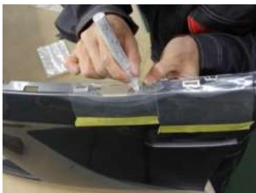
④脱脂・清掃をして、2液硬化型の接着剤を塗布します。
