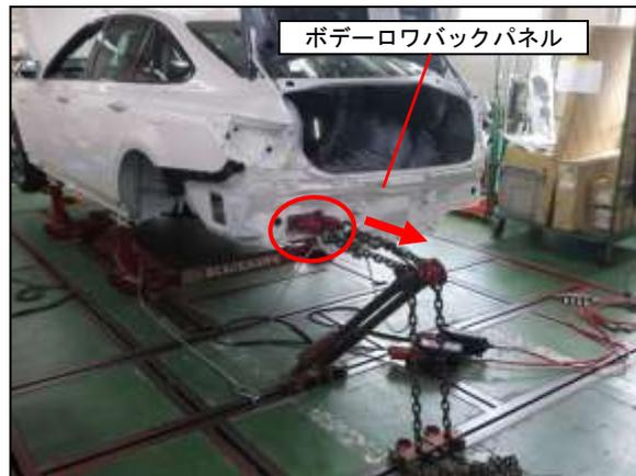
② 左側全体を引き出すため、ボデーロワバックパネルを取外して、左リヤフロアサイドメンバインホースメントリヤ後端部にクランプを取付け、6時方向へ引き作業を行いました。
