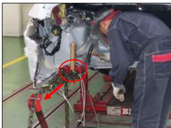
③ 左リヤフロアサイドメンバラインホースメントリヤを取外して、左リヤフロアサイドメンバ後端部にテンションを掛け修正しました。
