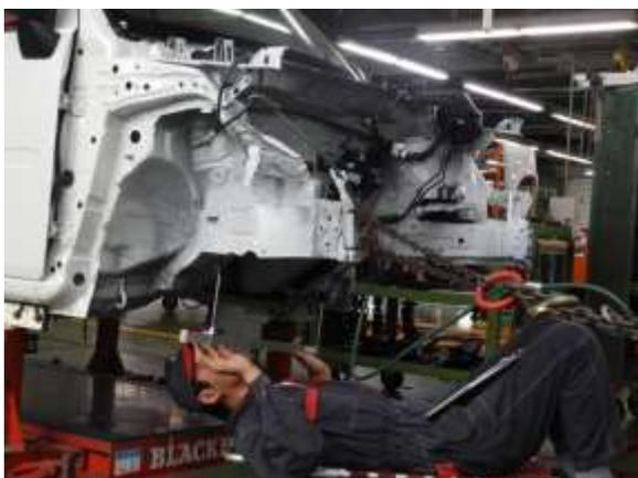
⑨左フロントサイドメンバサブ Assy にクランプを取付けて9時方向に水平引きを行い、寸法復元を確認しました。
