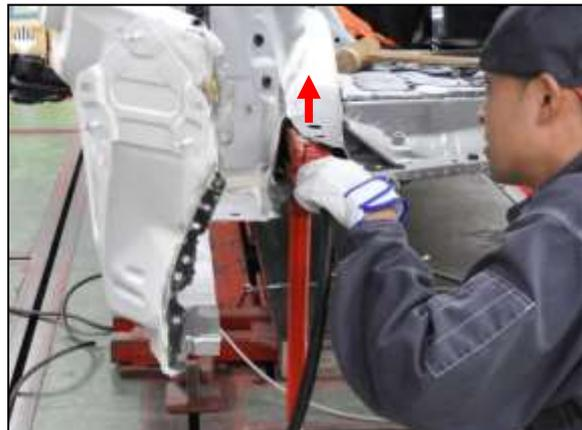
⑦ 左リヤフロアサイドメンバ右側面にプルプレートを溶接し、右方向へ引き出しました。
