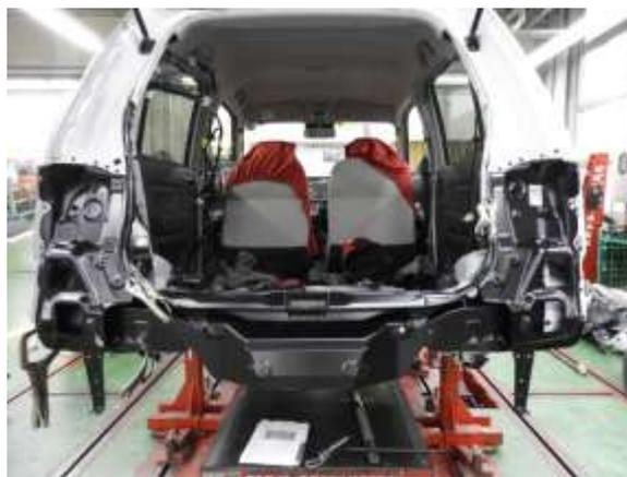
⑥リヤバンパカバー、左右リヤコンビネーションランプ Assy、バックドアパネルサブ Assy、左クォータパネルを取付けて立付けを確認しました。
