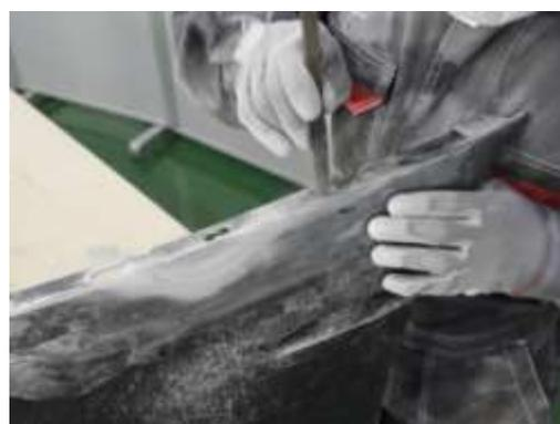
⑩パテベラで成形し、赤外線ヒータにて強制乾燥させます。
