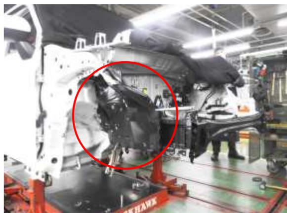
③ラジエータサポートサブ Assy を仮付けして全体の立付けを確認します。
