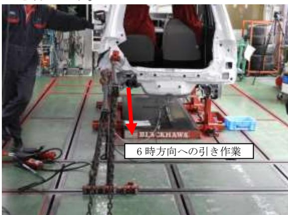
⑥引き作業により変形、寸法がおおむね修正されました。
