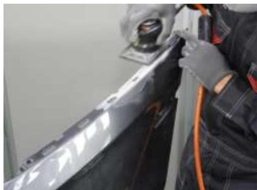
⑥接着剤の硬化を確認してからマーキングした輪郭線に沿ってカットします。
