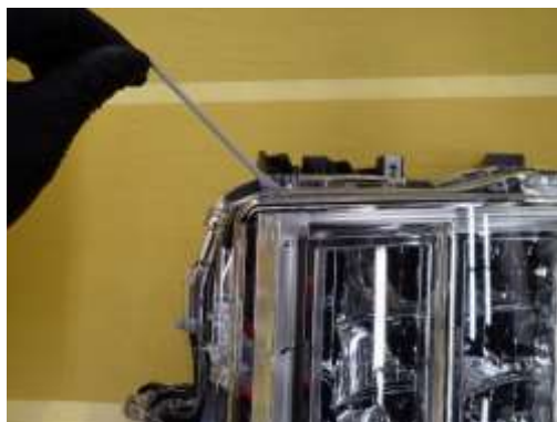
シーラント引っ張り
