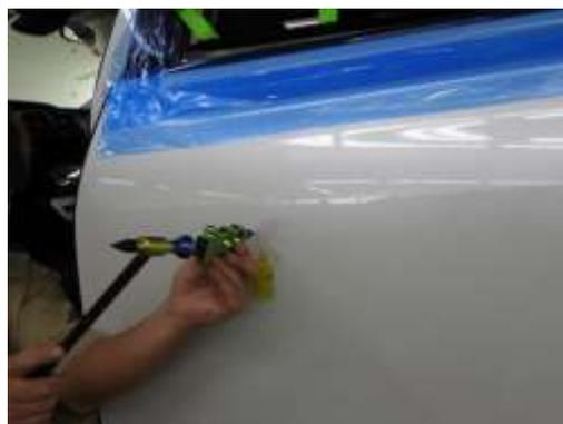
(5) 仕上げ作業(ぼかし作業)
