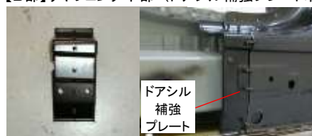
【B部】リヤフェンダ下部（ドアシル補強プレート取付けイメージ）
