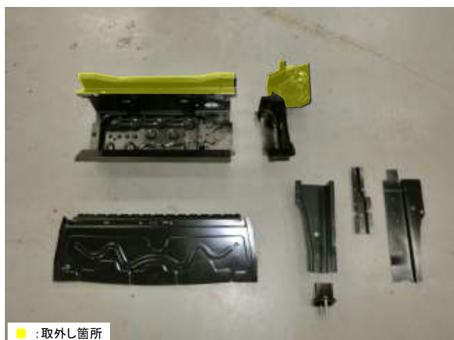
リヤサイドメンバおよびリヤサイドメンバ取付部周辺の構造
