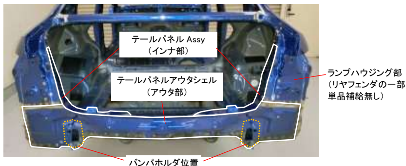
テールパネル周辺の構成部品 ※全て鋼板製
