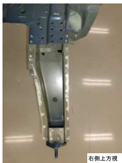
リヤサイドメンバおよびリヤサイドメンバ取付部周辺の構造
