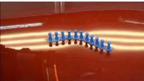
さらに引出した状態です。損傷中央部が周辺よりも引出し過ぎて凸になっているため、照明のラインが寄っているのが確認できます。
