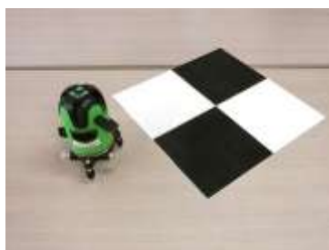
レーザ墨だし器とターゲット
