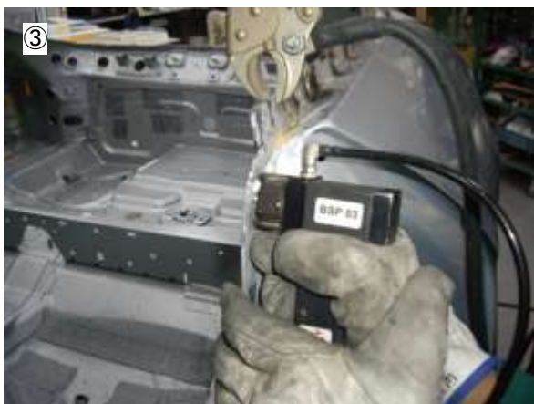
ドローピン溶着状態
