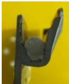
ハウジング溝 断面図
