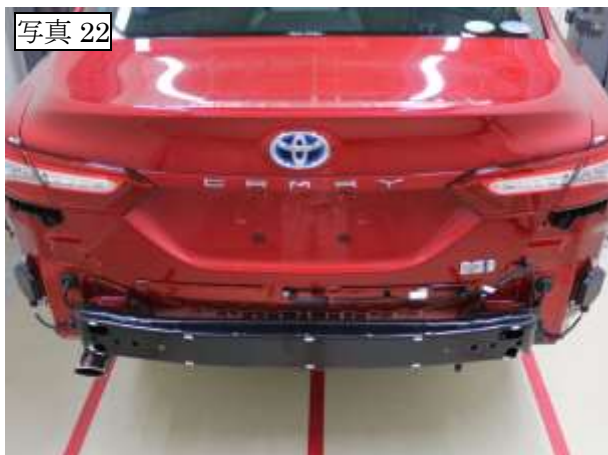
6 時方向から低速での衝突入力を受けた時の 車両の損傷
