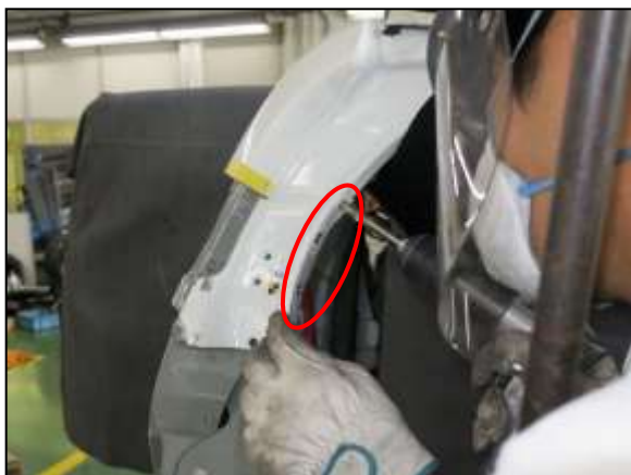
⑤ 左バックピラーレインフォースメントの奥にも溶接点があるので取外しました。
