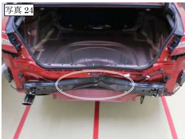
6 時方向から低速での衝突入力を受けた時の 車両の損傷
