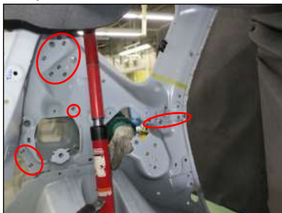
④ 室内側は、○部分にスポット溶接されています。
