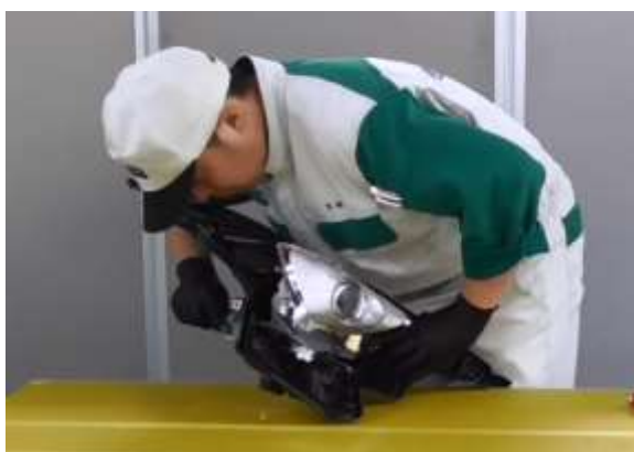
写真 13. ヘッドランプユニットの取付け
