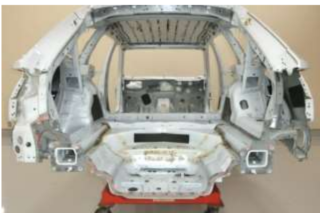
リヤクロスパネル、リインホースメントエンドプレート、テールライトマウンティング、インサートプレートロア取外し状態
