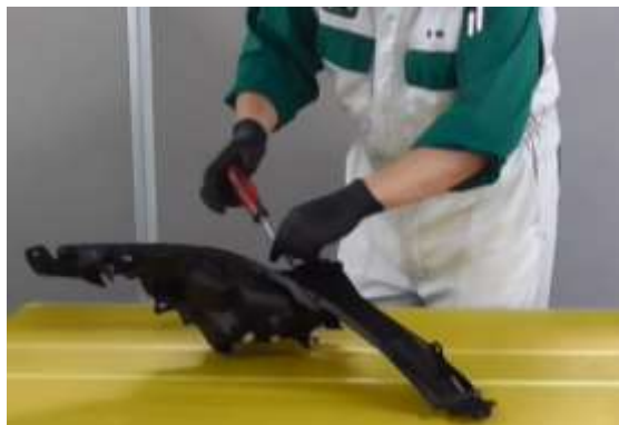
写真 10. ヘッドランプレベリングモータの取外し
