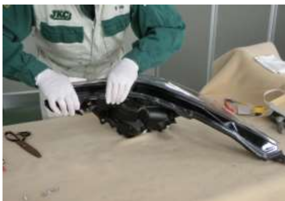
写真 17. ヘッドランプレンズの組付け
