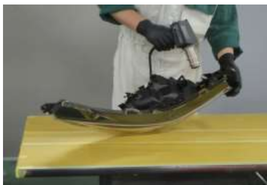
写真 4. ヘッドランプ裏面をドライヤーで温め
