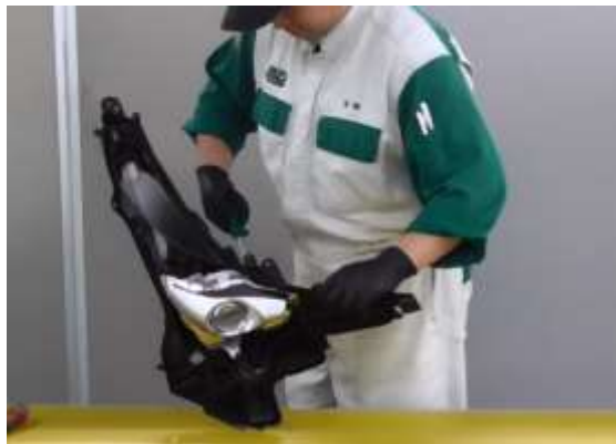
写真 7. 光軸調整用エイミングスクリュの裏面からの回転
