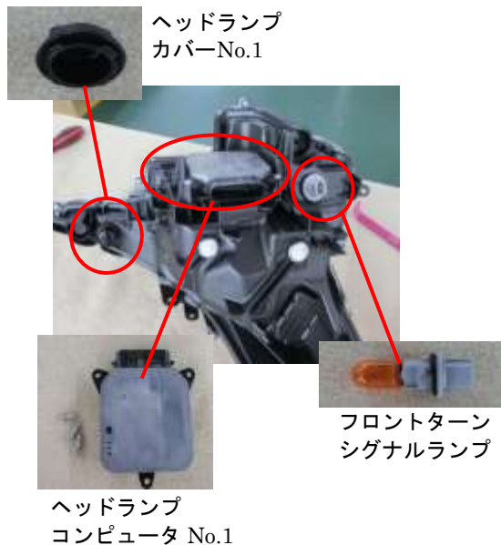
写真 3. ヘッドランプ裏面および取外し付属品
