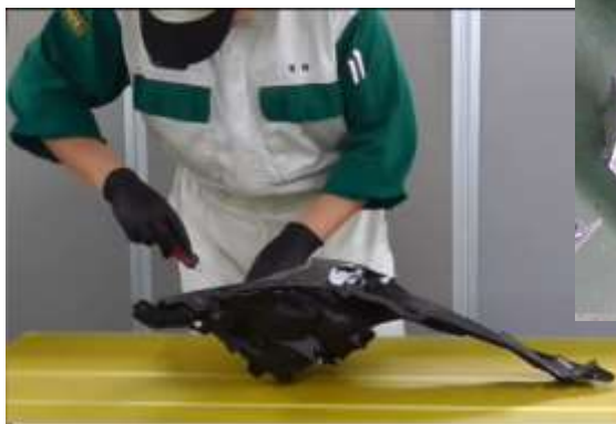
写真 6. リフレクタの取外し
