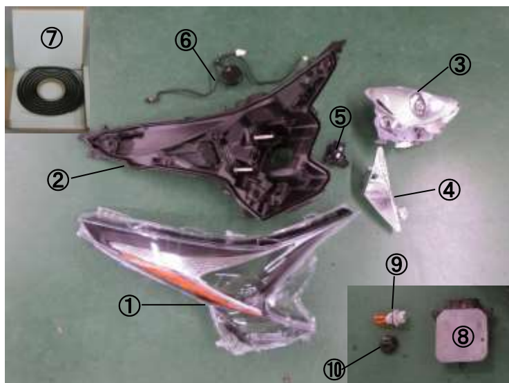
写真 1. ヘッドランプの部品構成図
