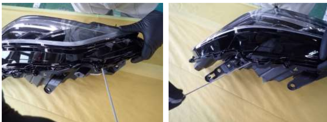
写真 3：ガスケット引出し
