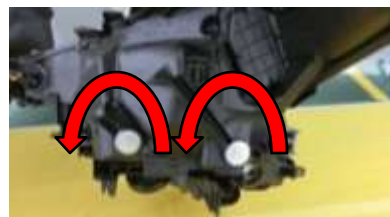
写真 8. 光軸調整用エイミングスクリュ および回転方向（矢印）
