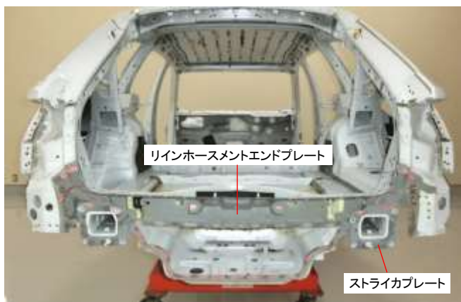
リヤクロスパネル取外し状態
