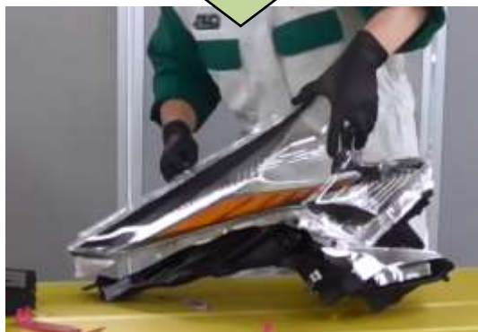
写真 5. ヘッドランプレンズの取外し
