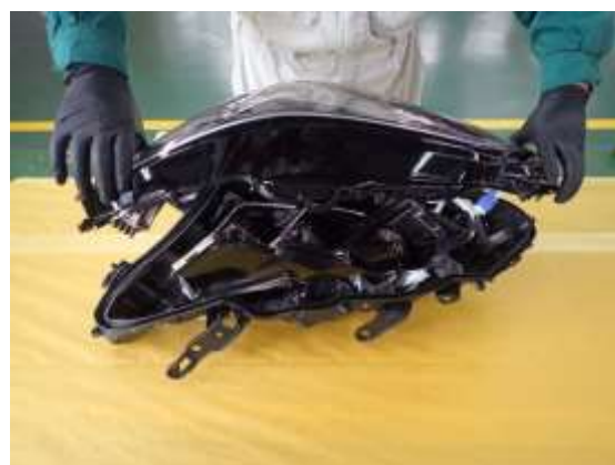
写真 4：レンズ取外し
