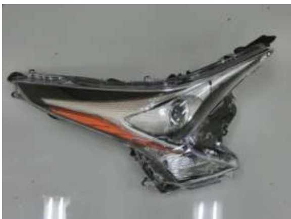
写真 18. 取替作業完了ヘッドランプ Assy 表面
