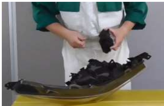
写真 2. ヘッドランプ付属品の取外し
