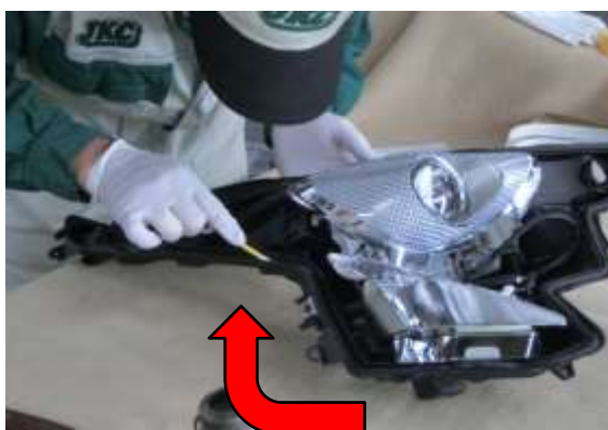
写真 15. 新品ヘッドランプガスケットの取付け
