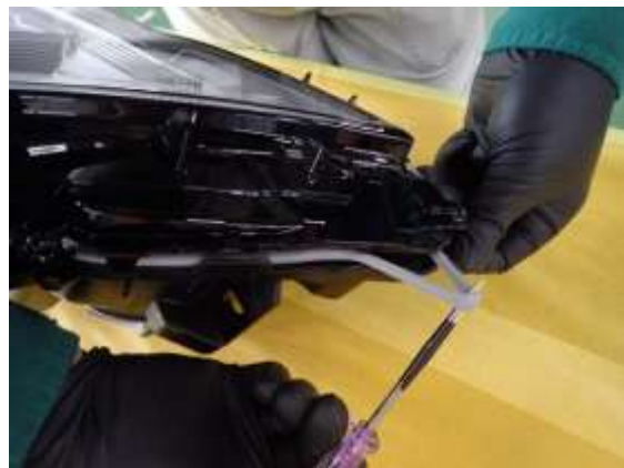
写真 2：ガスケット引出し
