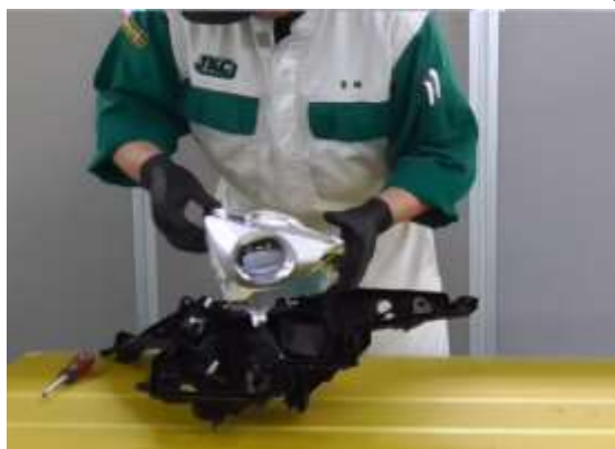
写真 9. ヘッドランプユニットの取外し
