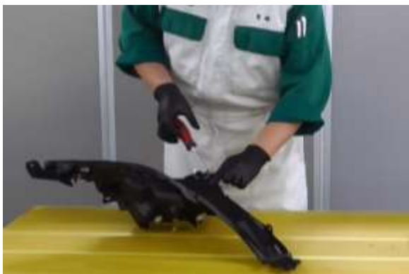
写真 12. ヘッドランプレベリングモータの取付け
