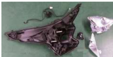
写真 11. ヘッドランプハウジング付属品取外し状態
