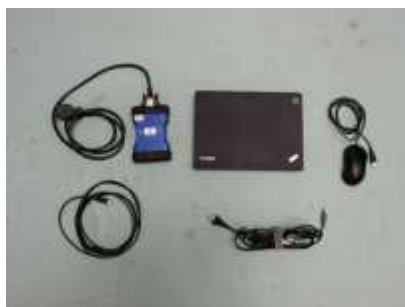
故障診断機材 (SDT-II をインストールした パソコンと車両通信インタフェース)
