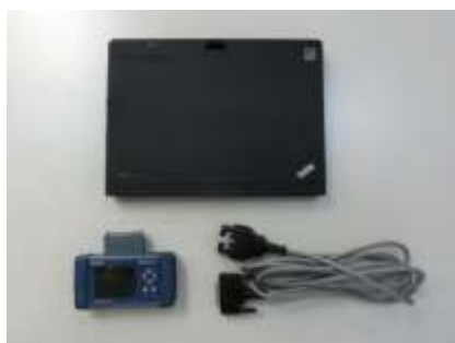
故障診断機材 (SSM4 をインストールした PC、 DST-i と接続ケーブル)
