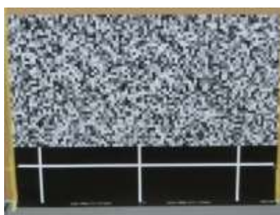
ステレオカメラ調整・検査用 ランダムチャート(スバル純正 SST)
