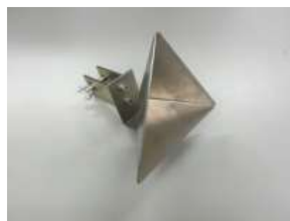
レーダ軸調整用レーダリフレクタ (スバル純正 SST、 使用時は三脚等と組み合わせて使用)
