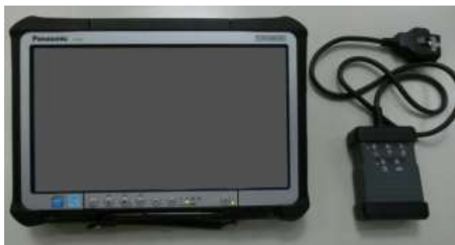
CONSULT-IIIplus (CONSULT-IIIplus をインストールした パソコンと車両通信インターフェース)
