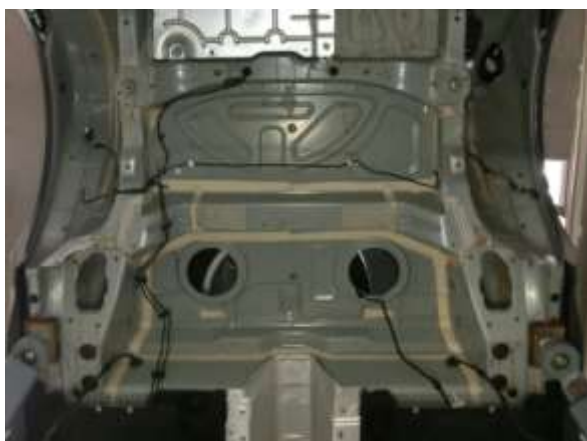
フューエルタンク取外し状態
