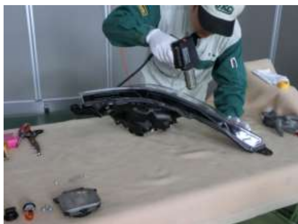
写真 6 ヘッドランプハウジングをドライヤーで温める
