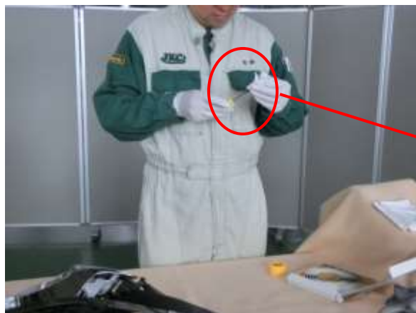
写真 12 ドライバへ離型紙を貼付け
