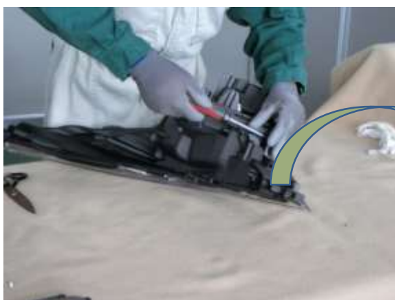
写真 5 トルクススクリューおよびスクリュー取外し
