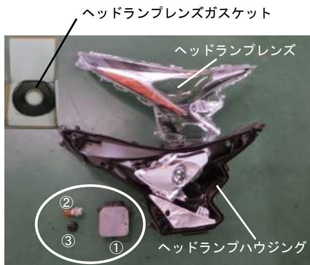
写真2 ヘッドランプレンズ取替作業での部品構成
