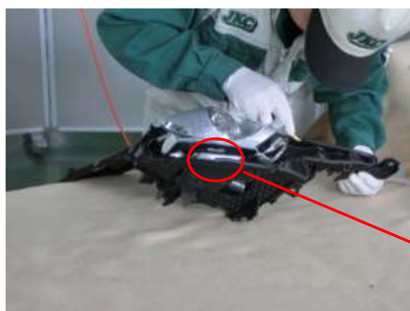
写真 14 ヘッドランプレンズガasketの押込み
