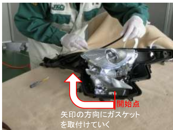
写真 13 ヘッドランプレンズガasketのセット
