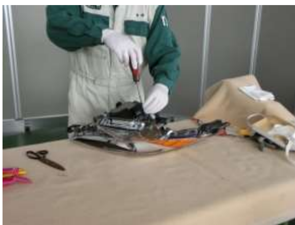
写真 18 ヘッドランプコンピュータ No1 の取付け
