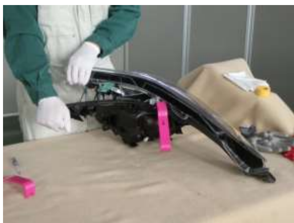
写真 8 ヘッドランプレンズの取外し
