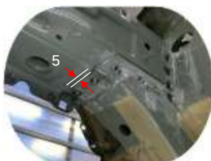
インナエンジンキャリア後部カット位置 リヤエンジンキャリアパネル端部より：5mm
