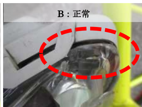
写真 1：浮き上がりによる圧着不足と正常圧着
