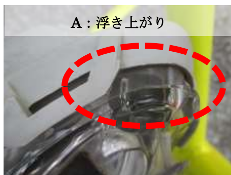
写真 1：浮き上がりによる圧着不足と正常圧着
