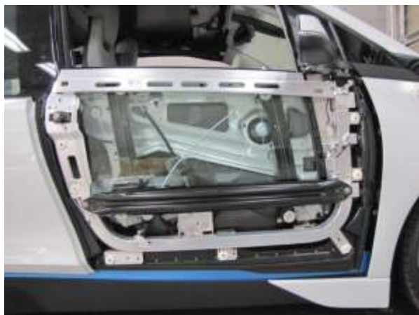
フロントドアアウトパネル取外し状態
