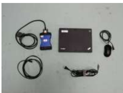
故障診断機材 (SDT-II をインストールした PC、 インタフェースと接続ケーブル)
