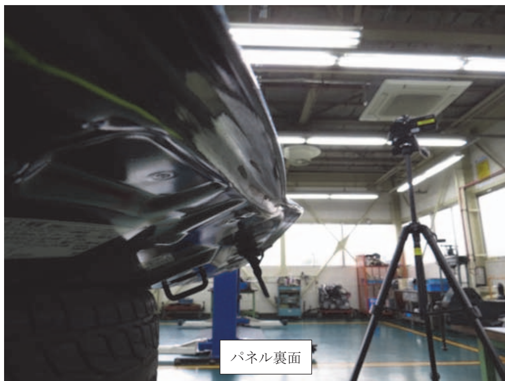
加熱修正後の状態
