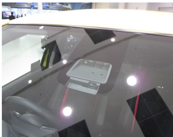
写真 8 単眼カメラと赤外線の併用例
