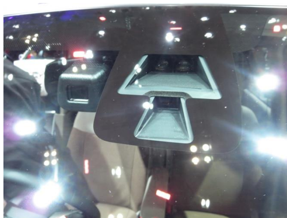
写真 8 単眼カメラと赤外線の併用例
