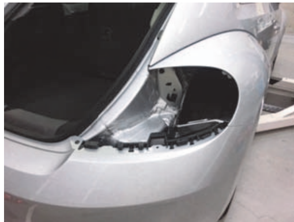
片側テールライト取外し状態
