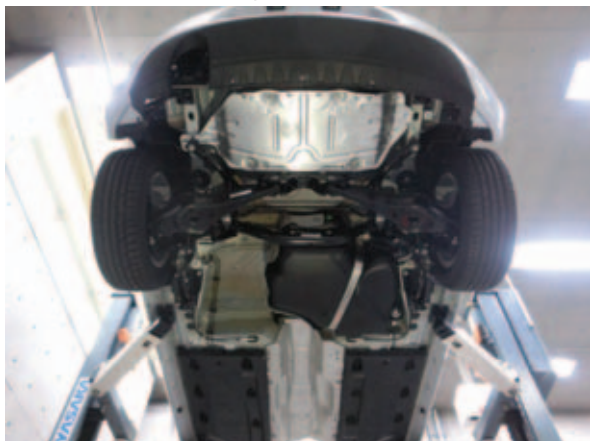
リヤサスペンション取外し状態
