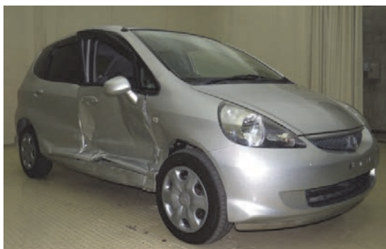
B 車 38.8km/h 走行 衝突後
