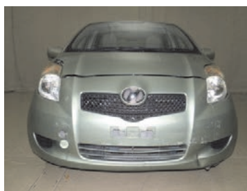
B 車 38.8km/h 走行 衝突後
