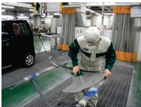
写真 5. 裏面、端部の足付け
