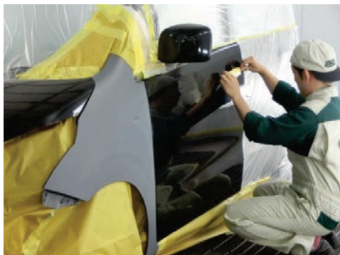
写真 13. 周辺部およびぼかし範囲の付属品のマスキング
