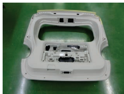
写真 4. 樹脂製バックドアパネル補給部品（裏面）
