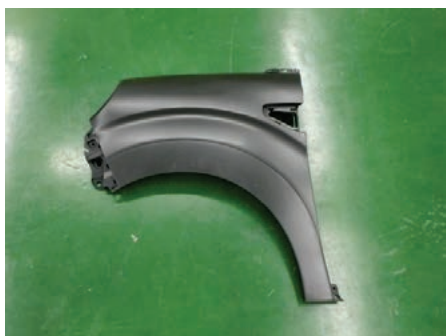
写真 1. 樹脂製フロントフェンダパネル補給部品（表面）
