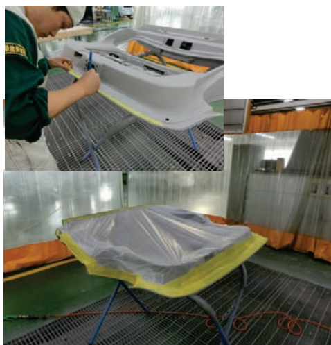
写真 19、20. トリム見切りおよび裏面全体のマスキング
