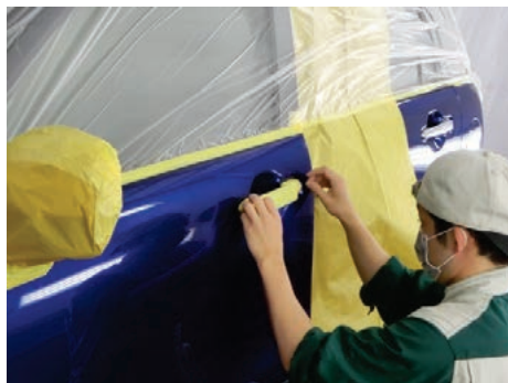
写真 15. 周辺部およびぼかし範囲の付属品のマスキング
