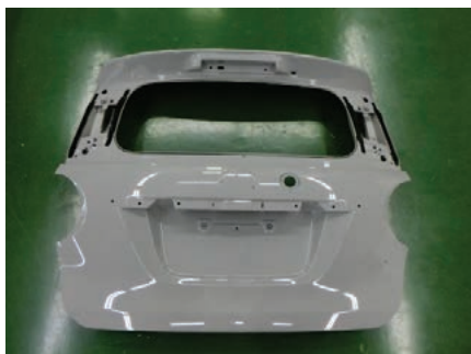
写真 3. 樹脂製バックドアパネル補給部品（表面）
