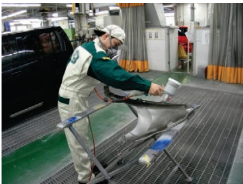
写真 6. 裏面、端部への上塗り塗料塗布
