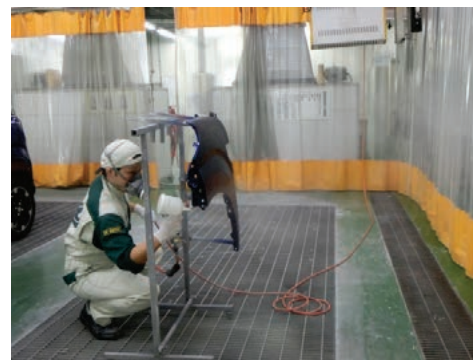
写真 8. 端部への上塗り塗料塗布
