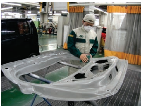
写真 17. 裏面、端部の足付け
