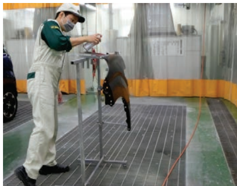
写真 7. 端部への PP プライマ塗布
