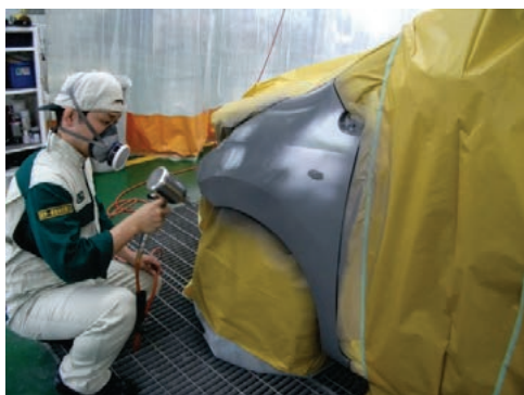
写真 10. プラサフマスキング後、 表面へのプラサフ塗布
