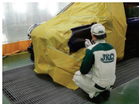
写真 11. プラサフマスキング後、 PP プライマ塗布
