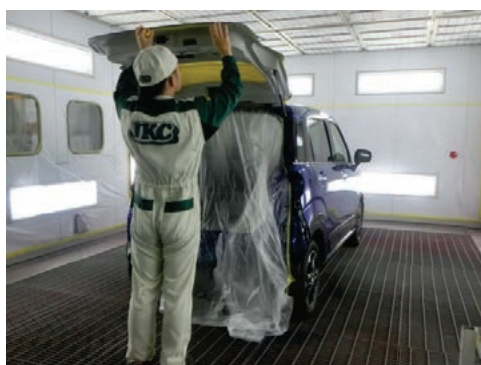
写真 27. トリム見切りおよび裏面周辺部のマスキング
