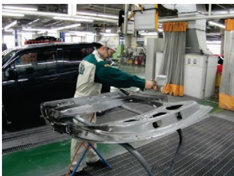
写真 18. 裏面、端部への上塗り塗料の塗布
