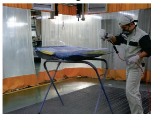
写真 21. 端部への上塗り塗料の塗布
