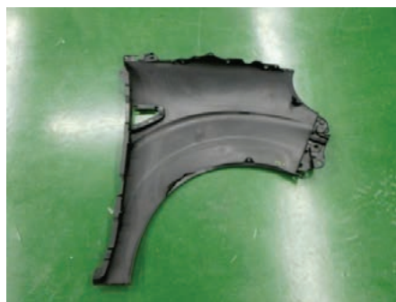
写真 2. 樹脂製フロントフェンダパネル補給部品（裏面）
