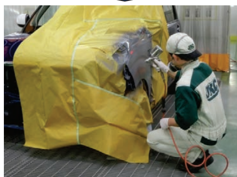
写真 12. 表面へのプラサフ塗布
