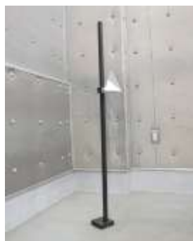
ミリメータウェーブレーダセンサ Assy 調整、 ブラインドスポットモニタ軸調整用リフレクタ
