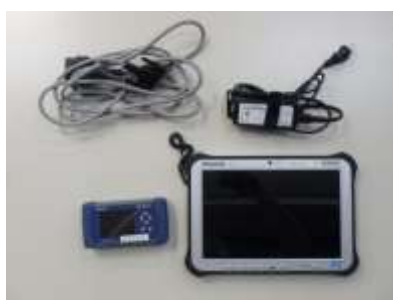
故障診断機材 (DS-ⅢをインストールしたPC、 インタフェースと接続ケーブル)
