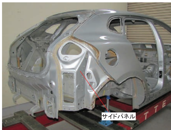
フレーム、インナリヤセクション、片側サイドパネル取付状態
