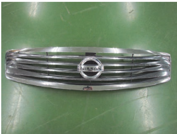
日産スカイライン（V36）フロントグリル メッキ部分に剥がれ、傷、くすみあり
