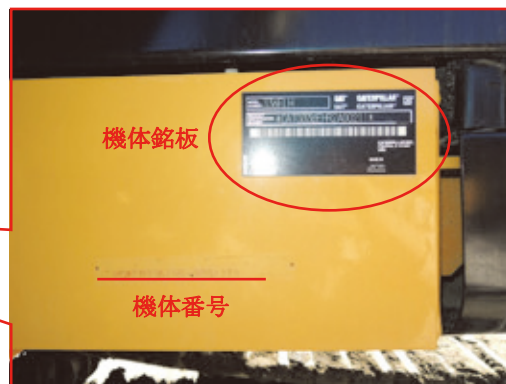
【写真 12】機体銘板・機体番号 同部拡大
