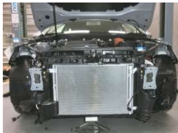
ドライヤ付きエアコンコンデンサ、ラジエータ取外し状態
