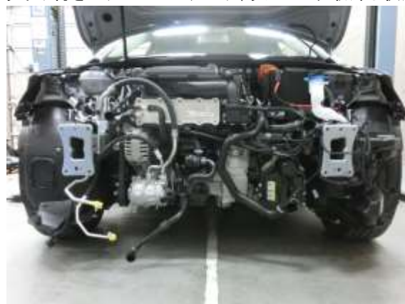
右側フロントフェンダ取外し状態
