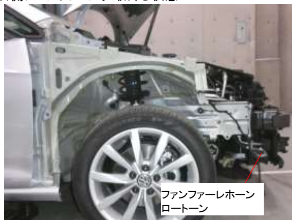
右側フロントフェンダ取外し状態
