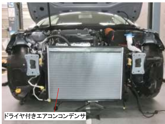
左側フロントフェンダ取外し状態
