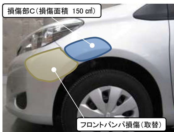
図 4 損傷イメージ（フロントフェンダ）
