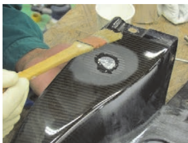
カーボンマットが必要以上裏面に飛び出ることを防止するため、部品の裏側からアルミテープを貼ります。
