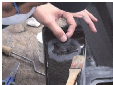
樹脂を塗布後、カーボンマットを更に上から貼付けます。
