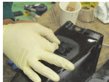
カーボンマットを貼付けます。
