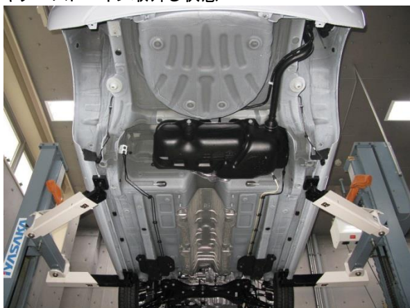
リヤサスペンション取外し状態
