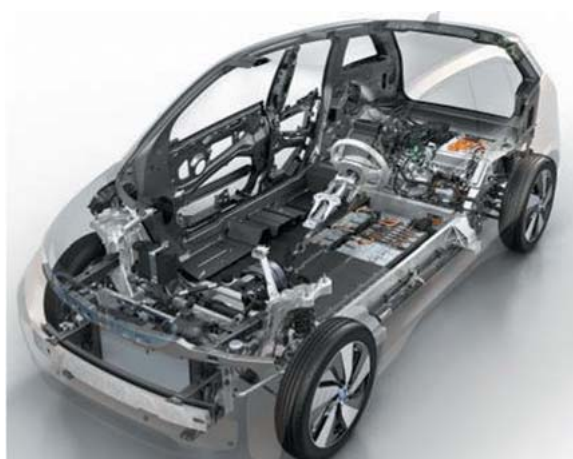
i3のレンジエクステンダ仕様。モータ横にエンジンを搭載するが、エンジンは発電専用
