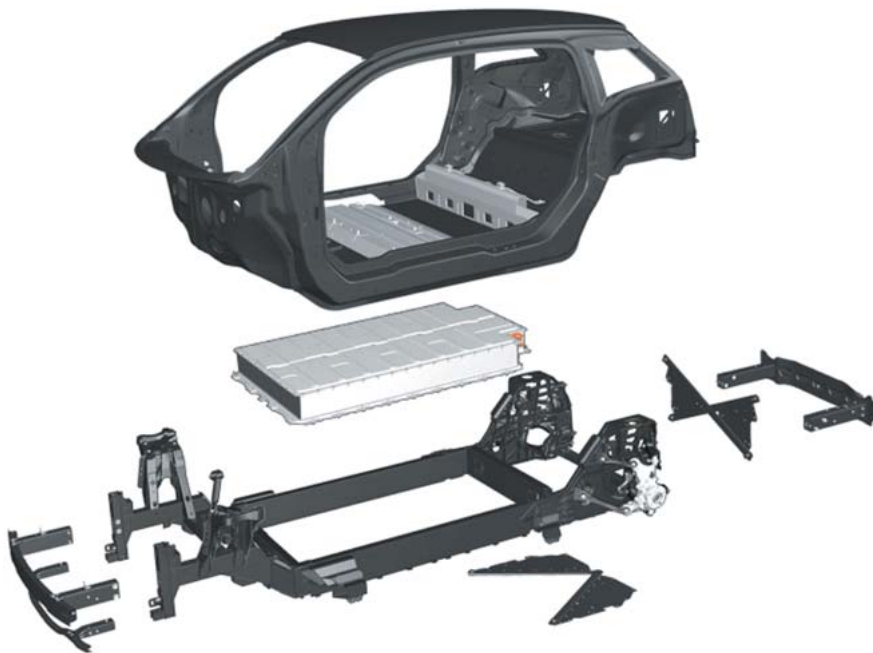
i3のフレームには、前後共に衝撃吸収部材が取り付けられている
