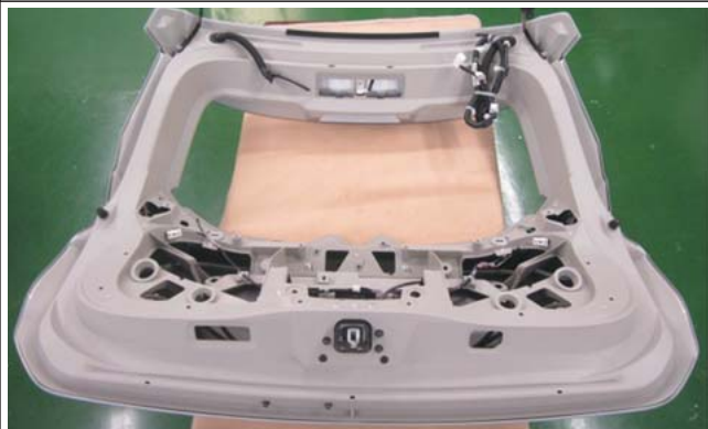
(3) 裏側は、トリムが取付いた状態で補給され分解できません。
