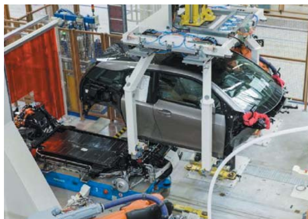
i3の生産ラインでの様子（ドライブモジュールとライフモジュールの組付け作業）
